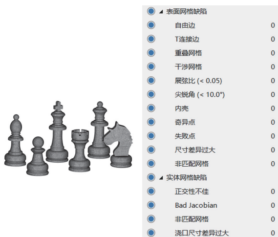
图5 棋子模型的网格建立和修复
